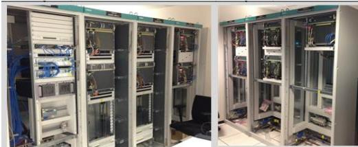
**Plutôt que de modéliser numériquement le Contrôle Commande, il est possible de raccorder une réplique du Contrôle Commande réel à un simulateur Temps Réel**
